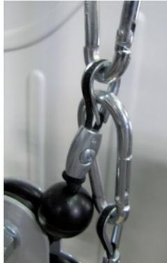
*Befestigung des Karabiners an der Öse positionieren*
