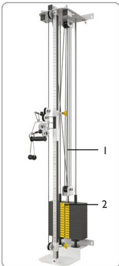
Bitte beachten Sie: Die Wandmontage des VECTOR CABLE muss fachgerecht ausgeführt werden. Die Firma ERGOFIT GmbH übernimmt für die Wandmontage keine Haftung. Der VECTOR CABLE muss an den 4 Befestigungspunkten befestigt werden, die Haltekraft pro Schraube/Dübel sollte mindestens 200 N betragen.
